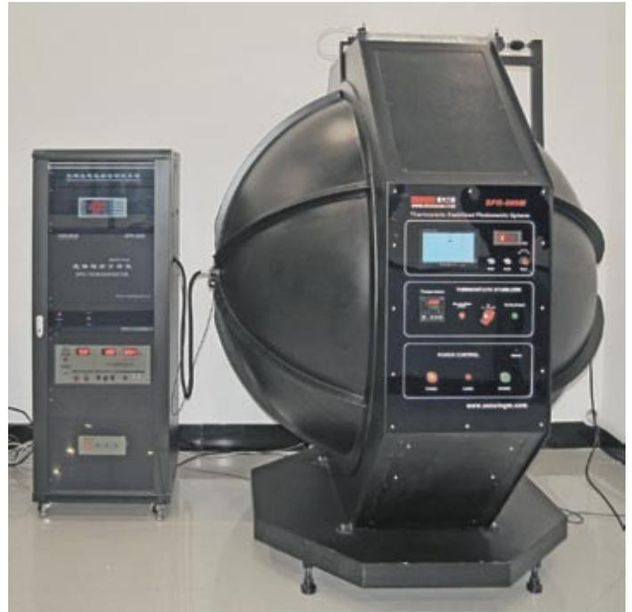
**Вверху.** Сфера для измерения светимости и прочих электрических и оптических параметров ламп.
