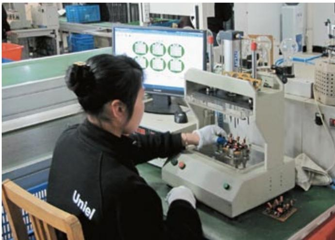
*Испытательная линия для проверки работы ламп при разных режимах электропитания (так называемая «aging line»).*
