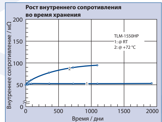
Рис. 3 Рост внутреннего сопротивления во время хранения
