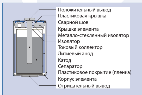
Рис. 1 Устройство литиевой батареи.
