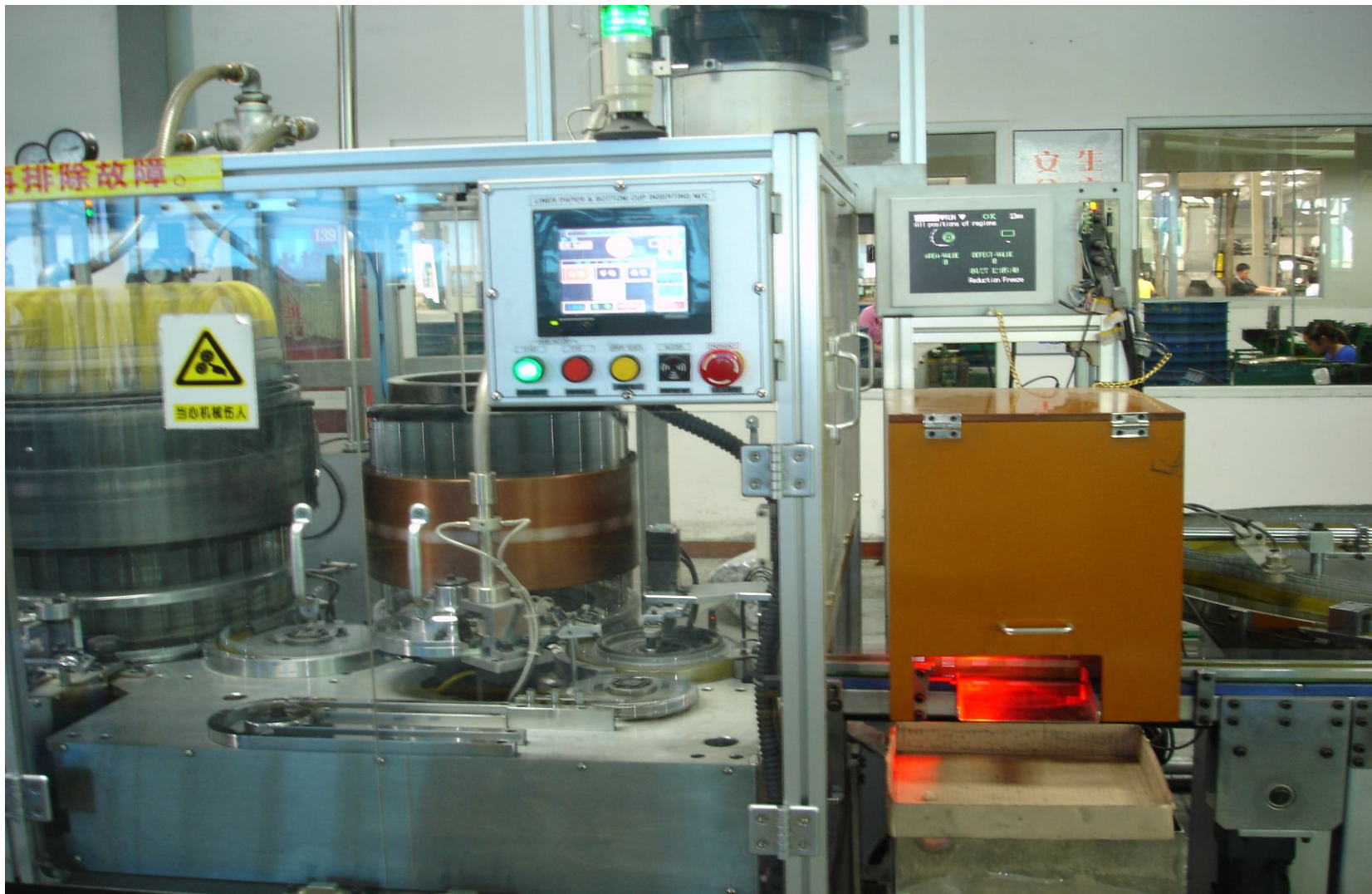
Проверка и установка сепаратора
