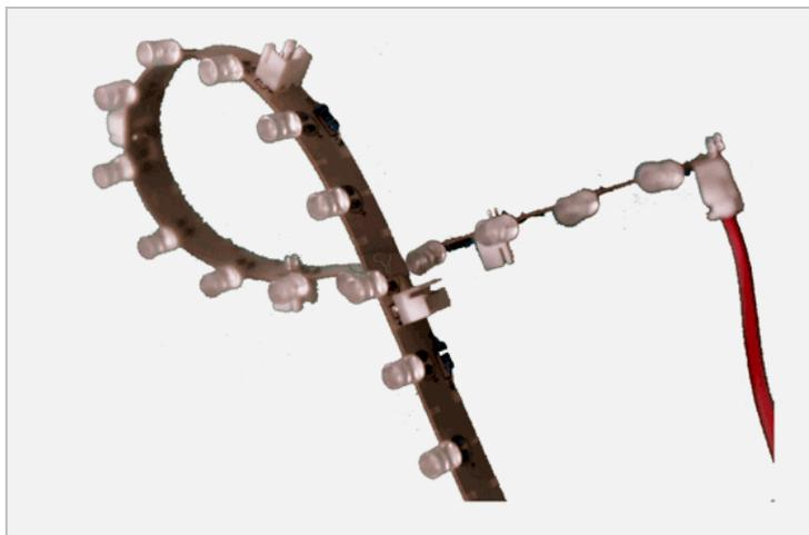
Современное изделие – узкая линейка из гибкого и прочного материала с расположенными на одинаковом расстоянии друг от друга 18-ю светодиодами.
