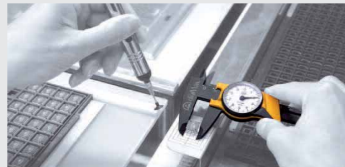
Штангенциркуль dialMax ESD позволяет проводить измерения чувствительных электронных деталей.
