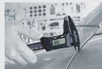
Измерительные губки армированных стекловолокном штангенциркулей позволяют проводить измерения на высокочувствительных, блестящих поверхностях без нанесения царапин.
